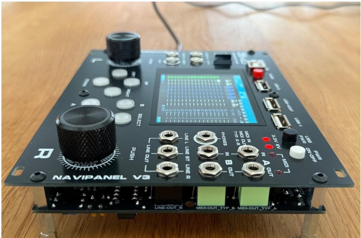
Beispiel: Fertiggerät das TFT-Display muss so bündig mit dem Frontpanel abschließen
