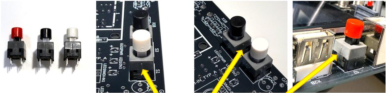
1. Taster S2 2. Schalter S3 und S1 auf die vertikale Markierung beim Einbau achten!
