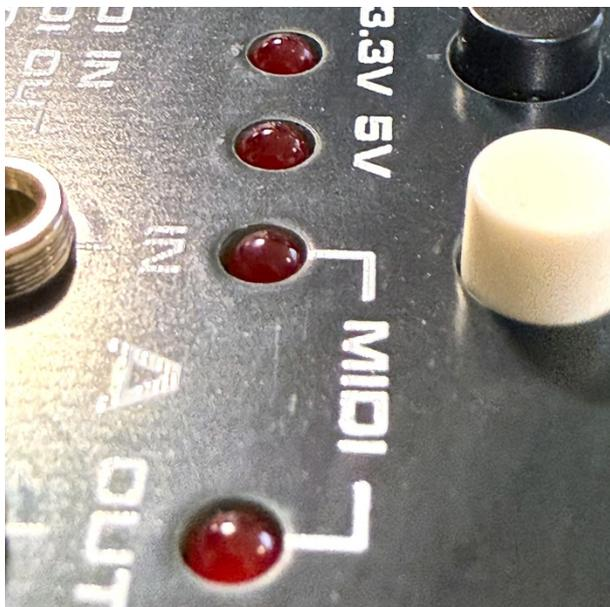
Die LEDs müssen gleichmäßig durch das Frontpanel schauen.
