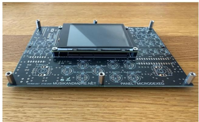
3,2“ Touch-TFT-Display befestigt mit M3x11 Stehbolzen für das Frontpanel
